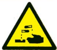
ระวังสารกัดกร่อน Corrosive substance
